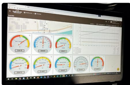
Caldia, freno di controcompressione, batteria e molto altro. Il cruscotto visualizza l'andamento della locomotiva a vapore.
