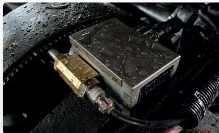
Des capteurs à ultrasons modernes surveillent les débits dans les conduites historiques - et résistent à toutes les intempéries.
