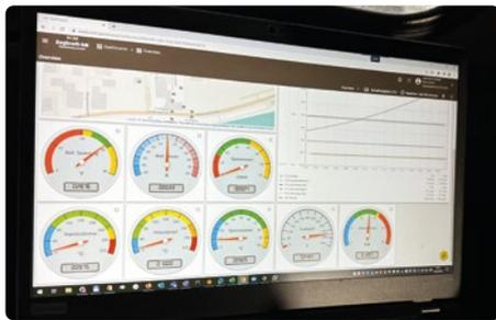
Kessel, Gegendruckbremse, Batterie und vieles mehr. Das Dashboard visualisiert, wie es der Dampflokomotive geht.
